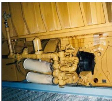
Eksplosion i gas motor - hullet ses til højre
